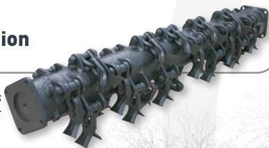
Rotor complet après reconditionnement
